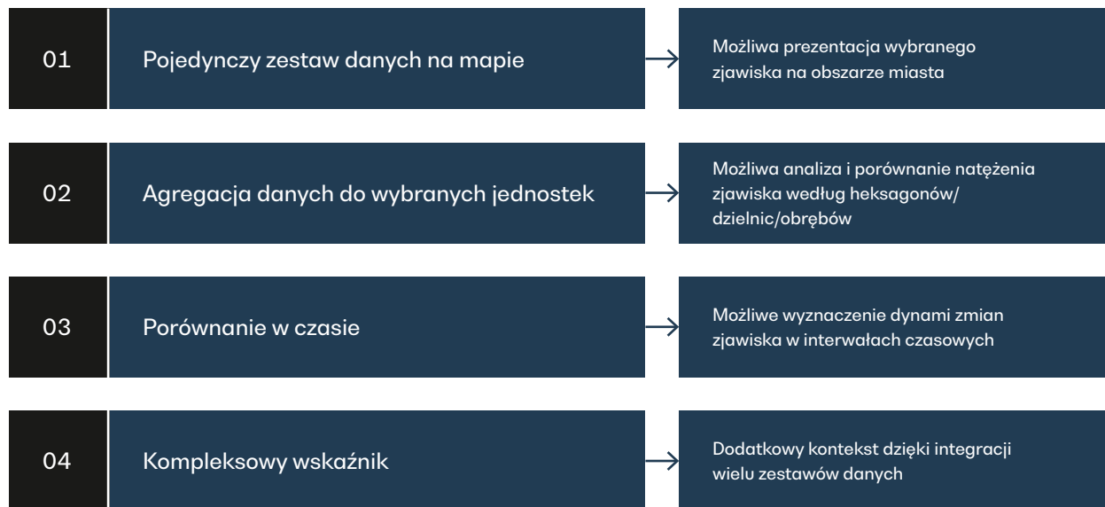
Ryc. 7.5.1. Schemat monitorowania zjawisk z uwzględnieniem zróżnicowania wewnętrznego
