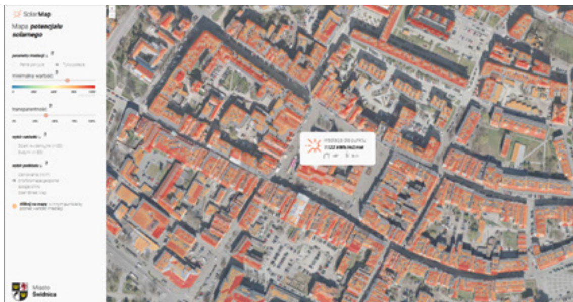
Ryc. 8.2.2. Mapa potencjału solarnego wraz ze wskaźnikiem irradycji dla wskazanego punktu
