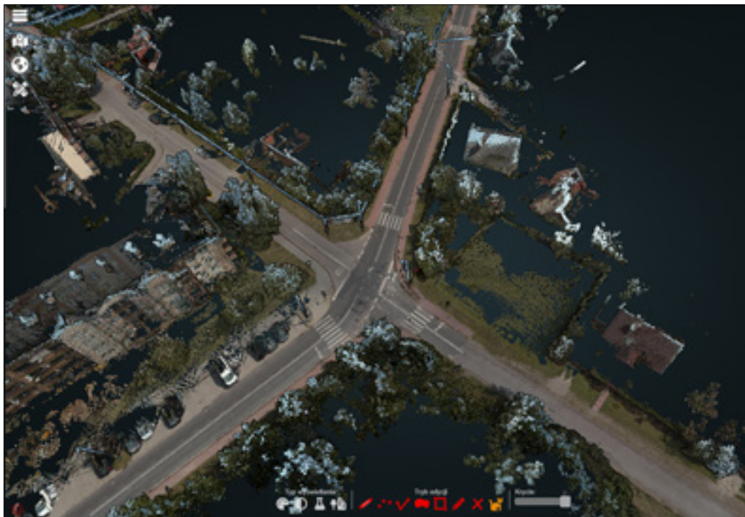
Ryc. 5.2.4. Chmura punktów 3D z mobilnego skanowania laserowego miasta Bielsko-Biała
