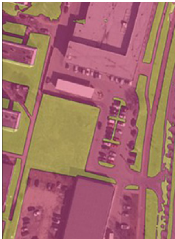
Ryc. 8.4.10. Produkt finalny modelu przedstawiający powierzchnie nieprzepuszczalne i przepuszczalne
