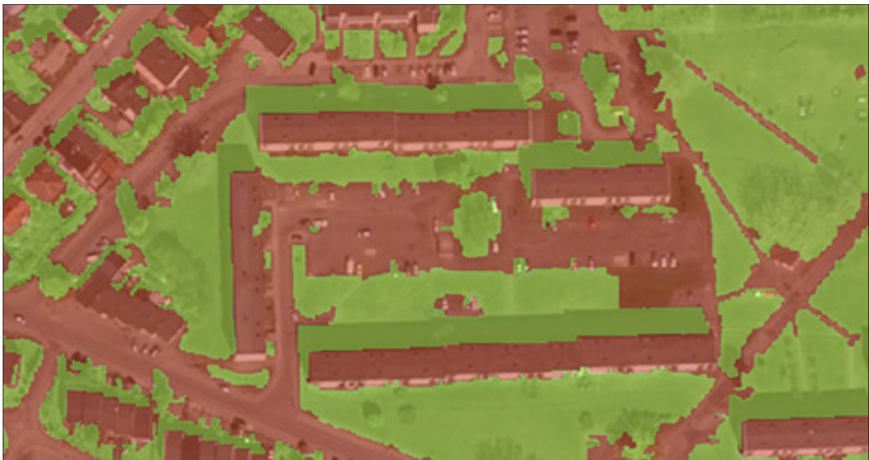
Ryc. 8.4.7. Wynik klasyfikacji na tle ortofotomapy (na zielono tereny przepuszczalne, na czerwono tereny nieprzepuszczalne)
